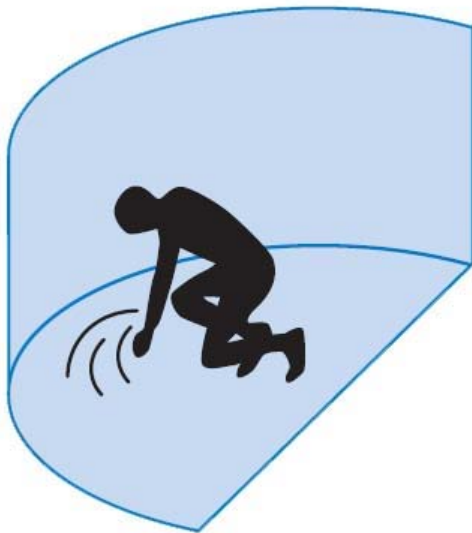
Abbildung 4: Glätten der Falten Rundpool
