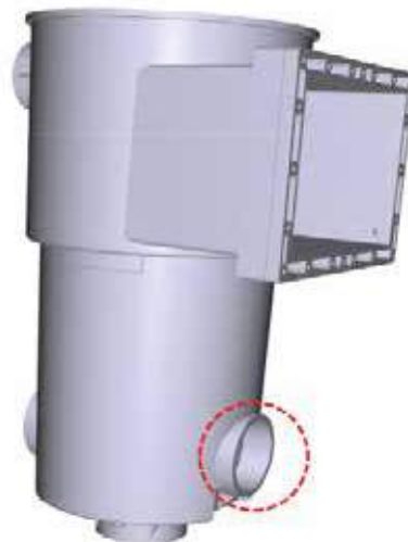
Abbildung 22 – Montage des Keils auf dem Skimmer
