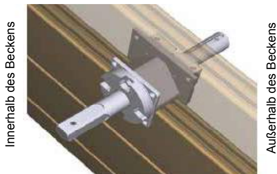
Abbildung 38 – Montage der Welle an der automatischen Abdeckung
