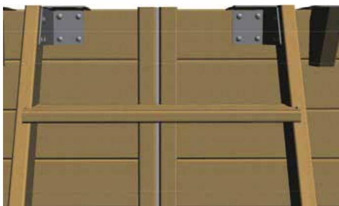
Anbringen der Außentreppe am Becken
