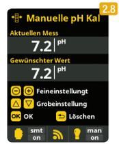
**2.8** Ohne die Sonde aus dem Wasser zu nehmen, benutzen Sie die + / - Tasten, um die Ablesung zu justieren, sodass sie mit Ihrem Referenzwert übereinstimmt (Fotometer oder andere Messung).
