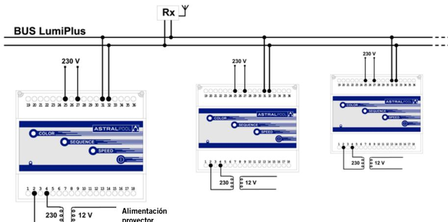
El número máximo de moduladores que se pueden sincronizar es 10, y el número máximo de antenas que podemos colocar en una misma instalación para tener el máximo de cobertura será de 3 antenas.
