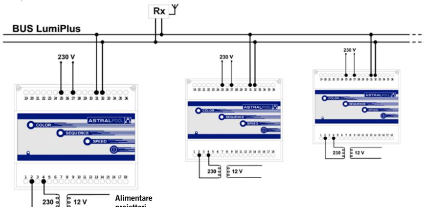
Il numero massimo di modulatori che si possono sincronizzare è di 10 unità, e il numero massimo di antenne che si possono collocare in un unico impianto, per ottenere il massimo di copertura, è di 3 unità.
