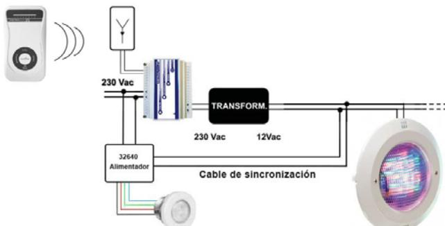
Esquema para Proyectores LumiPlus PAR56; Jelly; Plano y Standard para Fuentes con Mini y Micro.
