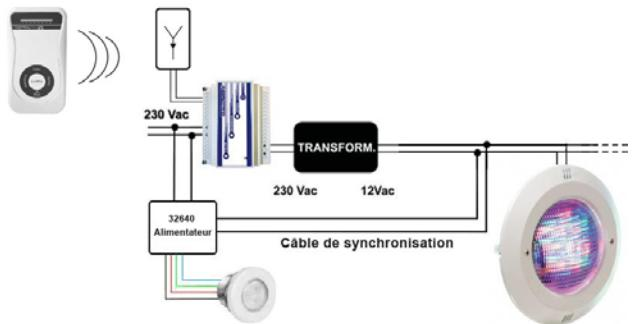
Schéma pour Projecteurs LumiPlus PAR56 ; Jelly ; Plat et Standard pour fontaines avec Mini et Micro
