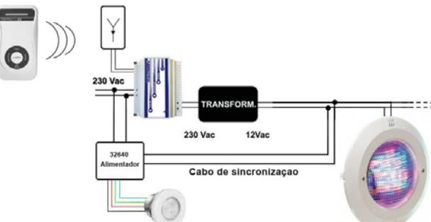
Diagrama para Projetores LumiPlus PAR56; Jelly; Plano e Standard para Fontes com Mini e Micro.
