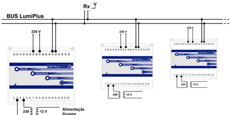
O número máximo de moduladores que podem ser sincronizados é de 10, e o número máximo de antenas que podemos colocar numa mesma instalação para obter a máxima cobertura será de 3 antenas.
