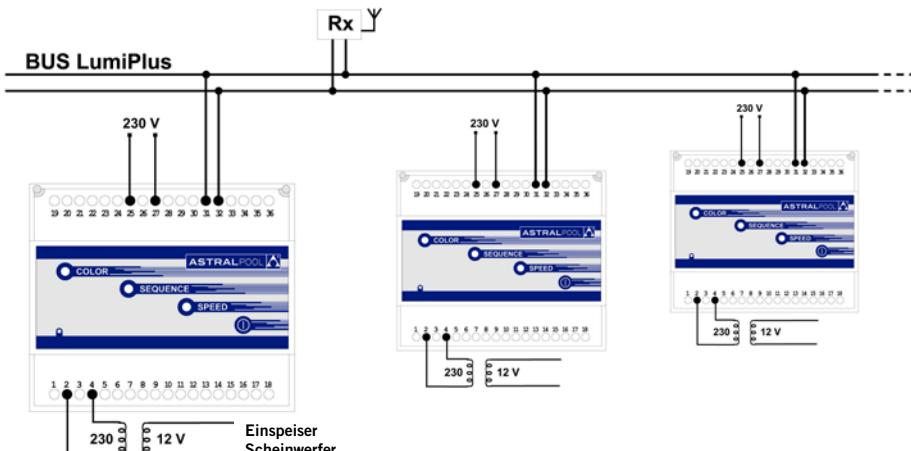
Die Verbindung erfolgt über eine Antenne mit einem Kabel mit zwei Drähten ohne Polarität, wobei man die Klemmen 31 und 32 an der Klemmleiste des Modulators benutzt.
