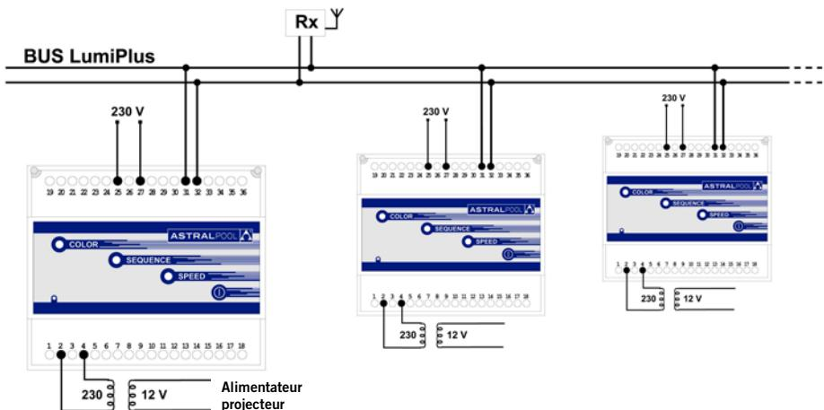
Le maximum de modulateurs pouvant être synchronisés est au nombre de 10 et le maximum d'antennes que vous pouvez poser dans une même installation pour avoir un maximum de couverture est au nombre de 3.
