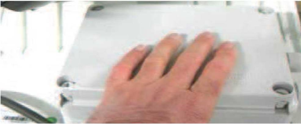
Benutzen Sie einen Schlitzschraubenzieher um die 4 Schrauben in jeder Ecke zu lösen und den Deckel zu entfernen.
