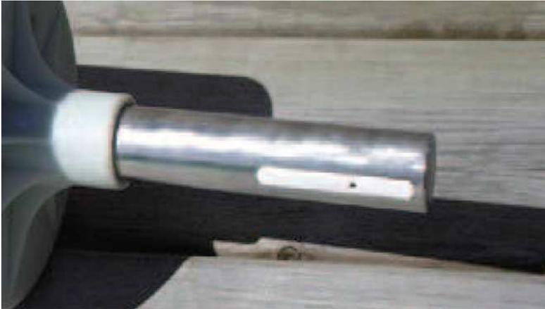
Positionieren Sie die Achse so, dass das Ende, an dem der Schlüsseltrieb angeschlossen wird, auf der Seite ist, auf der sich der Standfuß, der den Motor beinhaltet, befinden wird. Legen Sie die Achse auf einem z.B. durch Luftpolsterfolie gesicherten Boden, um Kratzer an der Oberfläche zu vermeiden.
